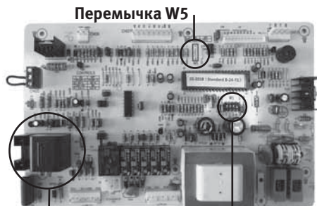
Перемычка W5 Трансформатор розжига черного цвета с надписью «TIME» DIP-микрореле-ключатели
